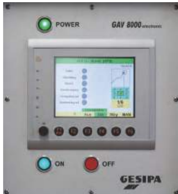
Display di una GAV 8000 electronic con visualizzata la curva come parte del sistema di controllo
